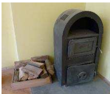
Slika 3-4 Pojedinačna peć na drva za grijanje prostora učina 5 kW – stupanj djelovanja 78,5 %
