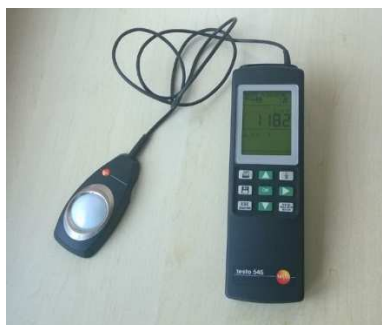
Slika 3-42 Luksmetar za mjerenje osvjetljenosti
