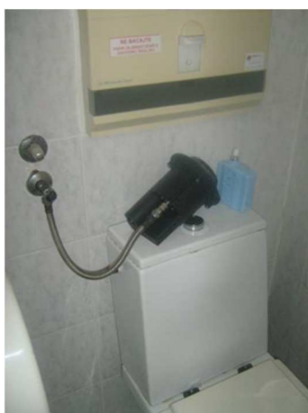
Slika 3-48 Mjerenje tlaka vode u vodovodnoj mreži u prizemlju i na 4. katu
