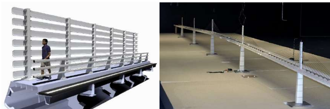
Slike 31,32. Ograda za zaštitu od vjetra i testiranja modela mosta (Full Bridge Model Test, 1:150) u vjetrovnem tunelu Force Technology / Kopenhagen - Danska
